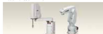
8. 工业用机器人: SCARA、多关节机械手臂
