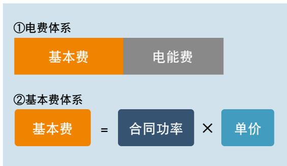
根据过去1年中的 **最大需求 (最大需求功率)** 计算
