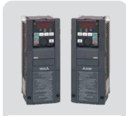
高水准驱动性能：具有独特的无传感器矢量控制模式，在不需采用编码器情况下可以使各式各样的机械设备在超低速区域高精度的运行带转矩控制模式，并且在速度控制模式下可以使用转矩限制功能、具有矢量控制功能（带编码器），变频器可以实现位置控制和快响应、高精度的速度控制（零速控制、伺服锁定等）及转矩控制，以驱动PM电机（永磁电机）以大大达到节能降耗的效果。
