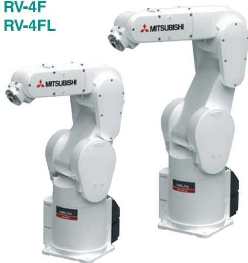
最新型的伺服控制、最佳化手臂结构设计，可以提升动作的速度、精度和性能。最大可搬运重量比传统机型的3Kg多1Kg。平型的手臂设计，使动作运行幅度更加适合小型区域。可以提高空间使用率。最适用于小部件的搬运、组装与检验工程。
