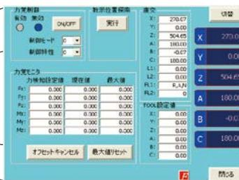
通过示教盒上的力觉控制专用画面，观察受力状态的同时进行示教。可实现最合适的位置示教。
