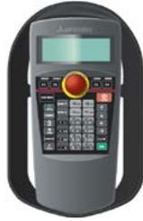
可进行程序编程、修改、管理及动作位置的示教, JOG进给等操作。为安全使用, 配备有3位置使能开关。当有复数台机器人时, 可交替连接一台示教单元使用。并可在切断电源下交替连接。
