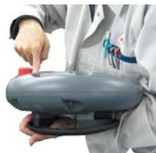
可用一只手握住把持盘固定示教单元，直接用该手指操作使能开关。并且，另一只手可操控触摸屏与按键操作。左右两手皆可操作。
