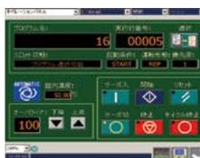
与机器人控制器的操作面板同等功能的机器人操作画面。可实现伺服开关、启动、停止、重置、程序选择等自动运行。
