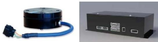
在通过力传感器与接口单元感受机械臂受力情况的同时，进行接近于人类的模仿操作、嵌合操作。可以进行需要精细力量控制、检测受力的操作。
